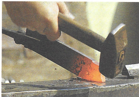
Železo je kovno, če ga segrejemo do določene temperature.
