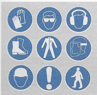
Znaki za uporabo osebne varovalne opreme
